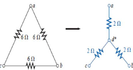
$$R_T = 2 \left[ \frac{(2 \Omega)(9 \Omega)}{2 \Omega + 9 \Omega} \right] = 3.2727 \Omega$$
