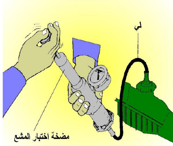
شكل ( ٢ - ١١ ) يبين اختبار تسريب سائل التبريد عن طريق زيادة الضغط داخل دائرة المشع
