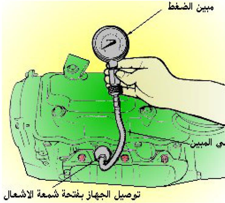
شكل (٢- ١٢) يبين طريقة توصيل مبين الضغط باختبار الضغط
