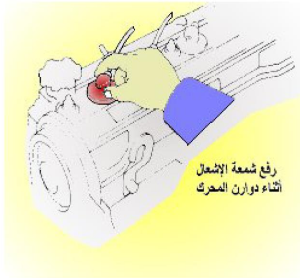
شكل ( ٢ - ١٦ ) يبين اختبار اتزان قدرة المحرك
