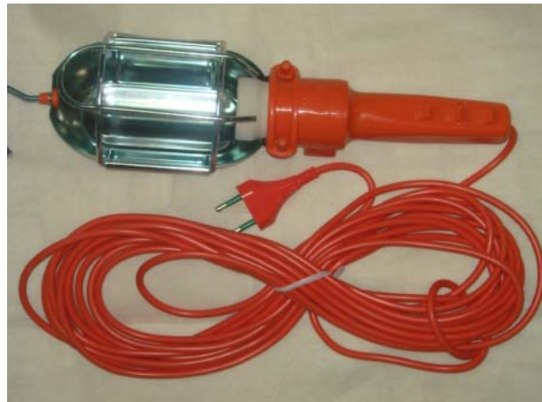
الشكل (٣- ٢٢) يبين مصباح الإضاءة الذي يستخدمه الفني في ورشة صيانة المركبات
