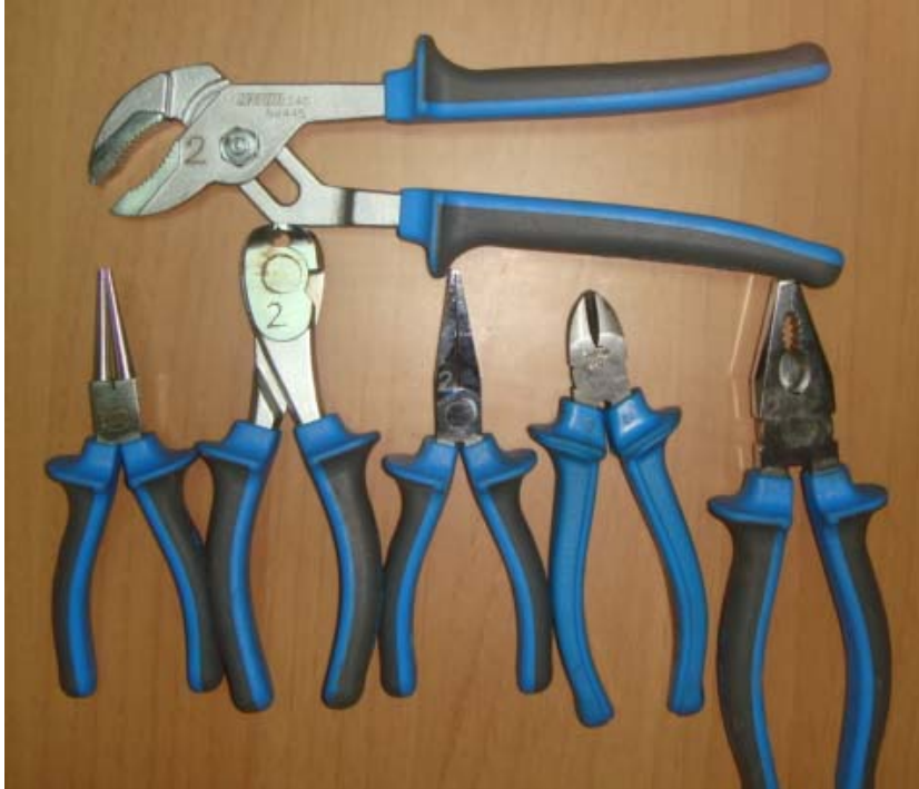
الشكل (٣- ١٤) يبين الأشكال المختلفة للزراديات التي يستخدمها الفني في ورشة صيانة المركبات
