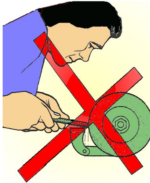
الشكل (٣ - ٩) يبين الطريقة الخاطئة عند استخدام جهاز الجلخ
