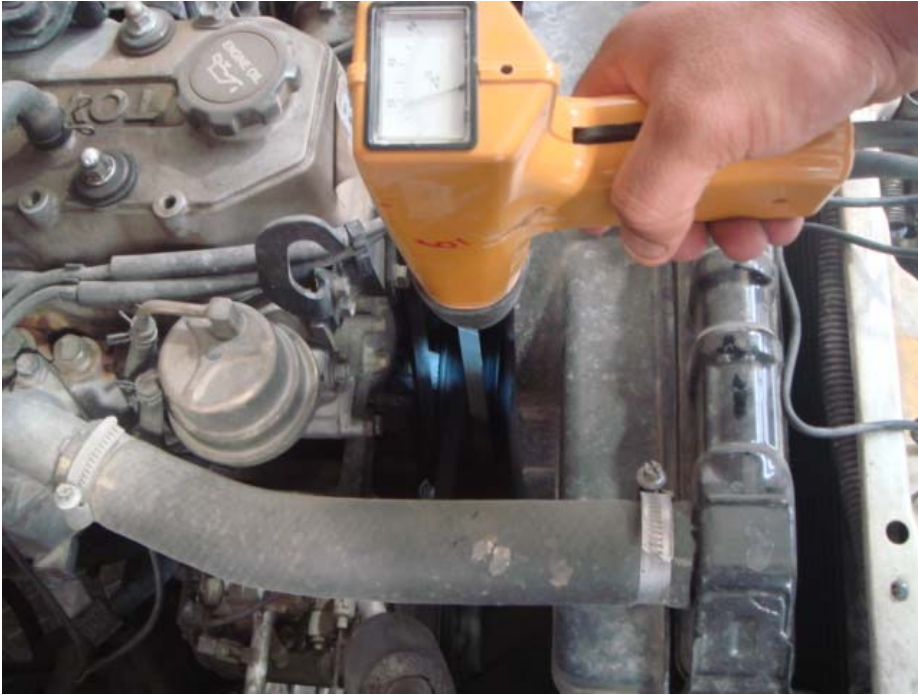
الشكل (٣- ٥) يبين جهاز ضبط توقيت الإشعال الذي يستخدمه الفني في ورشة صيانة المركبات
