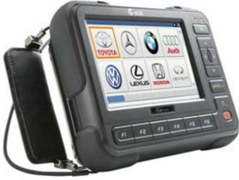
الشكل ( 8 ): جهاز فحص إلكتروني Scan tool
