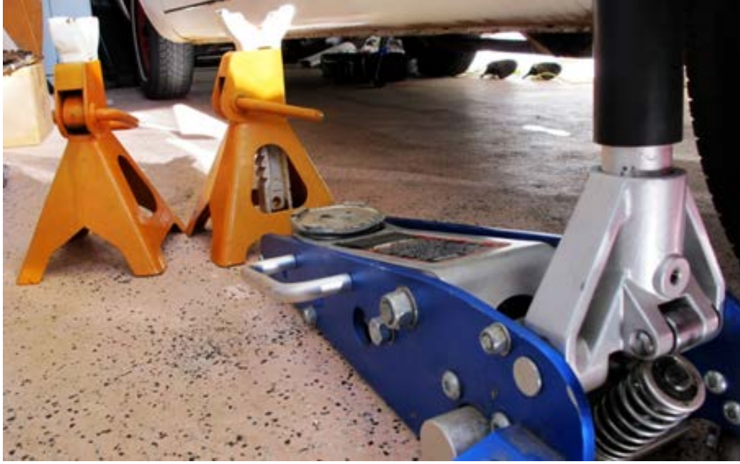
الشكل (6): الرافعة الهيدرولية نوع التماسح
