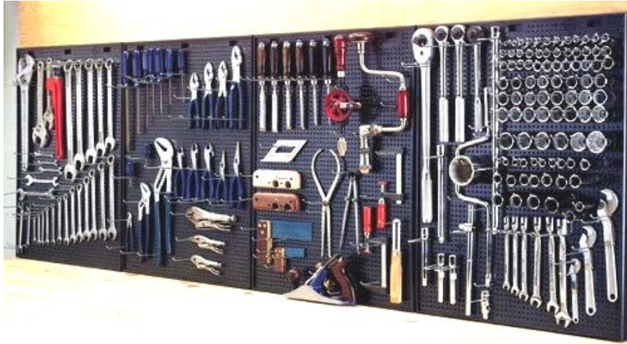
الشكل (4): لوحة جدارية خاصة بترتيب العدد (1) ومن العدد اليدوية والواجب توافرها في الورشة مما هو مبين في الجدول (1) الجدول (1) : بعض العدد اليدوية الواجب توافرها في الورشة
