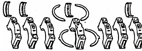
شكل ٤ - ٢٤ يوضح كراسي تثبيت عمود المرفق والجلب والهلالات
