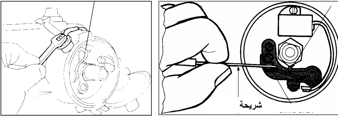
شكل ٨ - ٢ طريقة وزن الخلوص بين نقاط التلامس باستعمال شريحة القياس.
