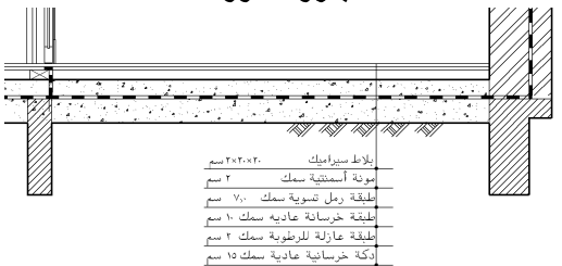
شكل رقم (١٣) الطبقة العازلة للرطوبة في حمام بدور بدروم
