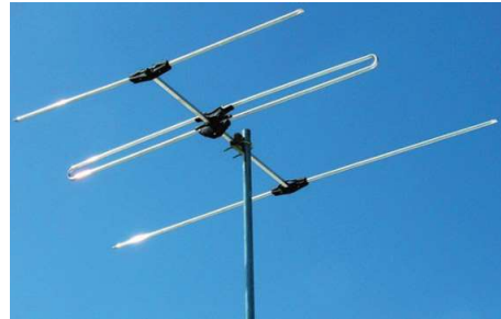
شكل (1): هوائي ياغي- أودا مختلفان في شكل الدايبول والأبعاد وعدد العناصر وتردد الموجة
